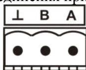
Рисунок 3.5 Вид разъема RS-485
